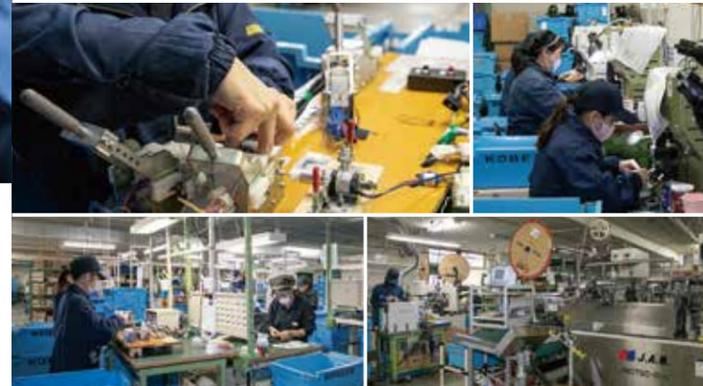
組立は電線を束ねるテープを巻く回数、分岐させる角度などが実に細かく決められており、機械化が難しい作業です。ハーネスは図面通りに作ることが重要で、精密さ、正確さが求められます。この仕事を支えているのが女性スタッフのきめ細やかさで、現在勤める約80名のスタッフのうち8割が女性です。
